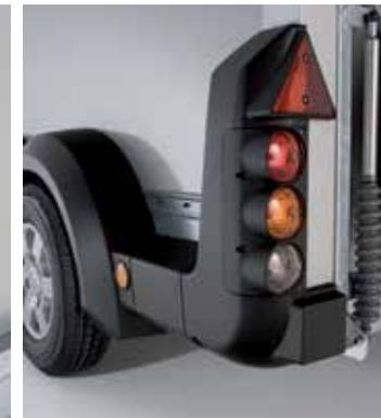
**Heckbeleuchtung mit integriertem Rückfahrlicht**
