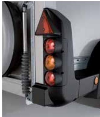
**Gasdruckfeder an der Heckrampe**
